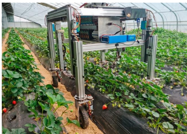
Рисунок 5 – Опытный образец земляникоуборочного робота
