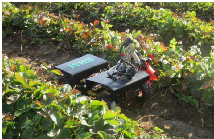
Рисунок 2 – Макетный образец автоматизированного манипулятора для сбора ягод земляники
