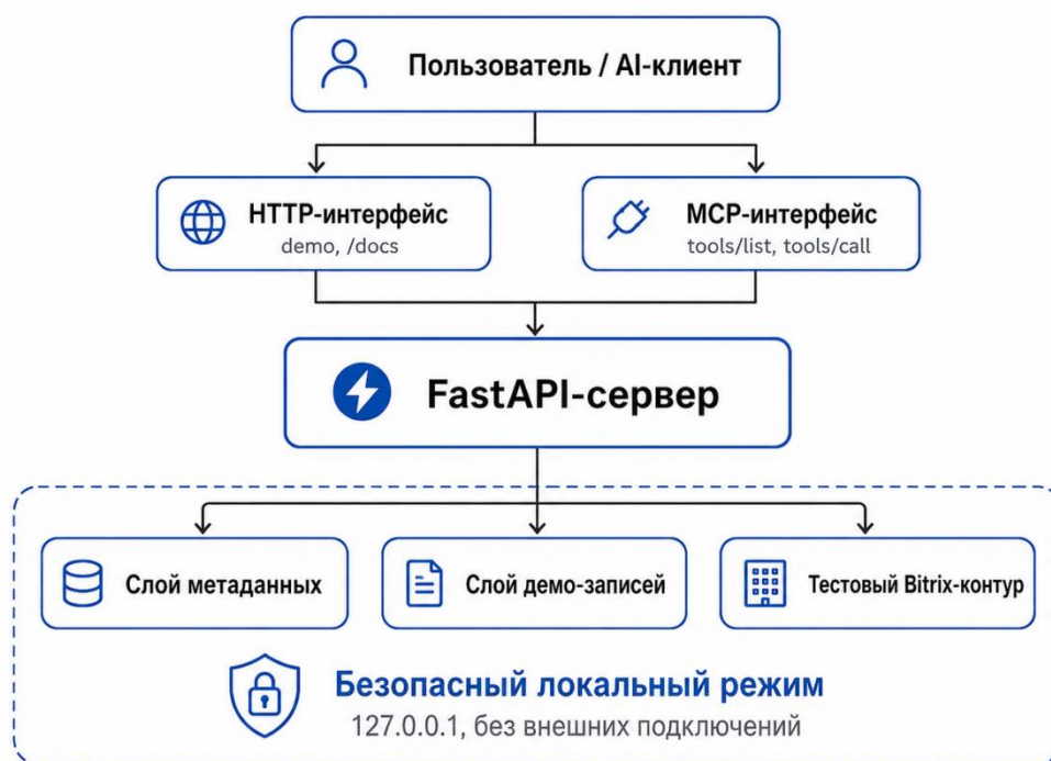
Рисунок 1 – Общая архитектура демонстрационного прототипа
