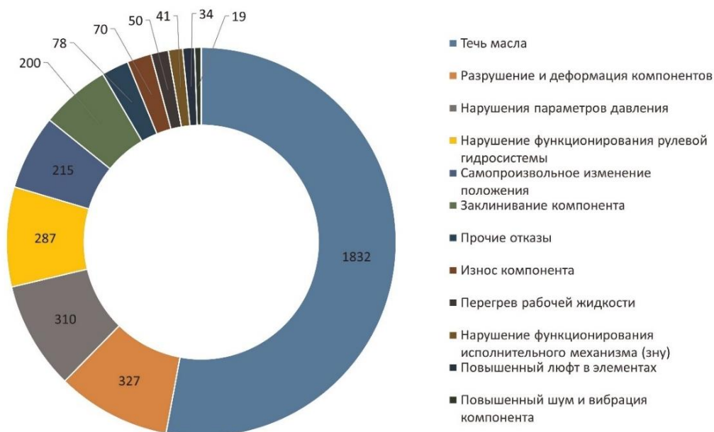
Рисунок 2 – Виды отказов гидравлической системы трактора
