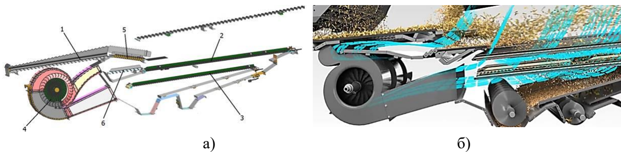
Рисунок 1 - Схемы очисток гибридных зерноуборочных комбайнов: а) по патенту RU 2 852 263 с наклонным решетом; б) Аналогичная без наклонного решета
