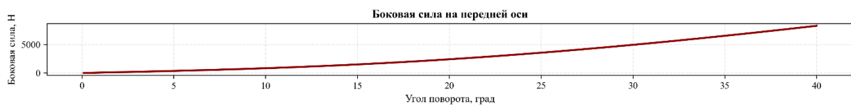
Рисунок 5 – Боковая сила на передней оси (уплотненный грунт)
