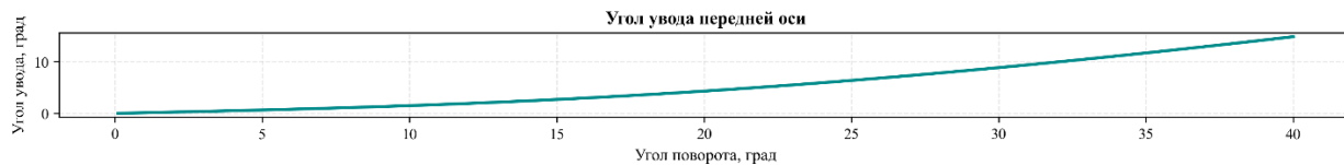
Рисунок 4 – Угол увода передней оси (уплотненный грунт)
