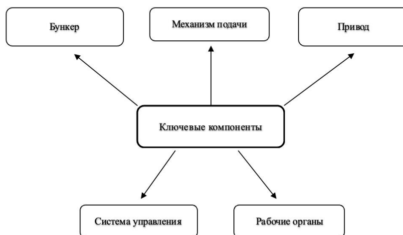
Рисунок 3 – Структурная схема автоматизированной системы кормораздачи
