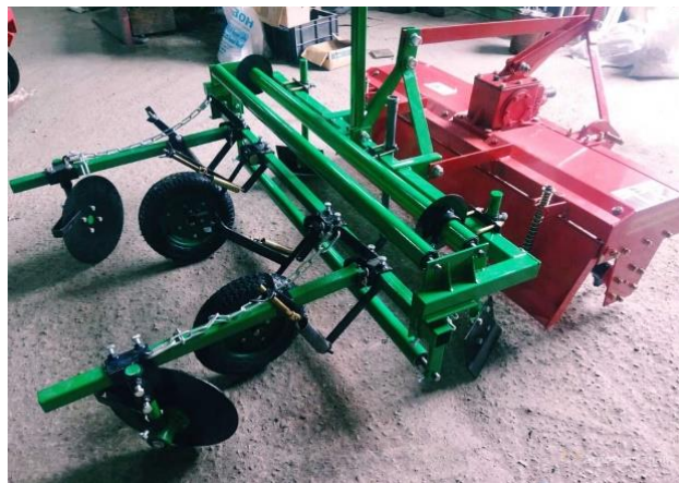
Рисунок 3 – Пленкоукладчик с почвофрезой для лучшего крошения почвы
