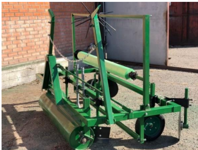
Рисунок 2 – Пленкоукладчик классический с отвальчиками для ровной укладки
