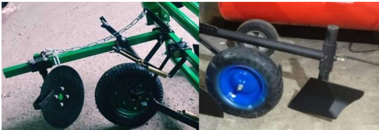
Рисунок 5 – Виды заделывающих рабочих органов: сферические диски и отвалы
