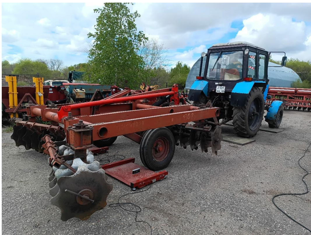
Рисунок 3 – К определению силовой нагрузки на адаптированную дисковую борону БДТ-3
