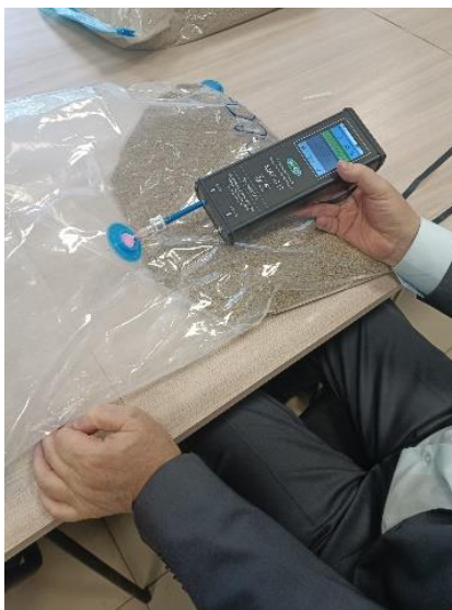
Рисунок 2 – Анализ состояния газовой среды в контейнере
