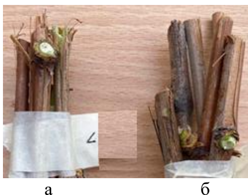
Рисунок 3 – Срезы лозы при различной форме ножей: (а) прямым ножом ( \varphi = 90^\circ ); (б) разработанным криволинейным ножом ( \varphi \approx 75^\circ )
