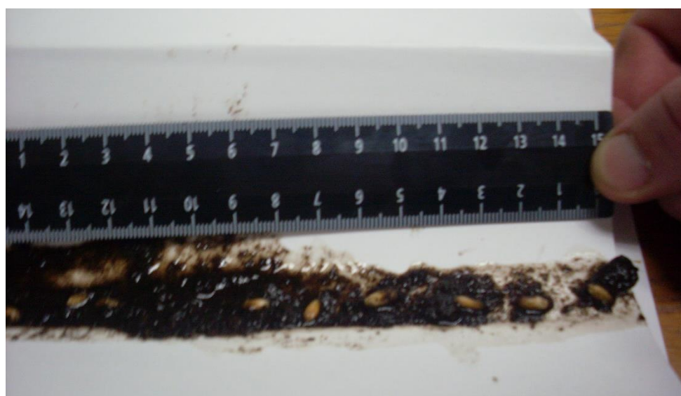
Рисунок 9 Распределение семян пастообразной смеси в макете профиля борозды
