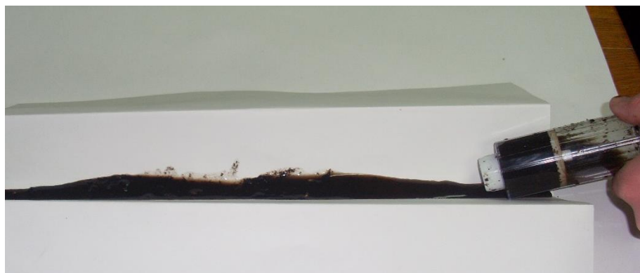
Рисунок 8 Посев пастообразной смеси в макет борозды
