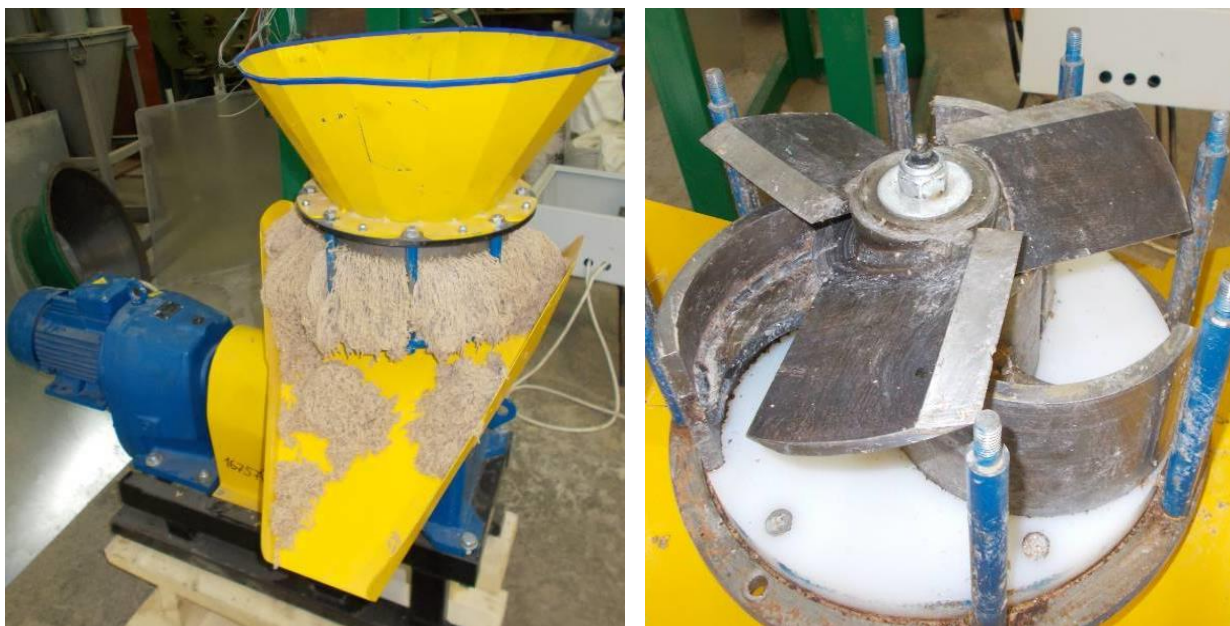
Рисунок 1. Корзинный гранулятор, разработанный «Аграрный научный центр «Донской» и его рабочие органы (патент RU 218265)
