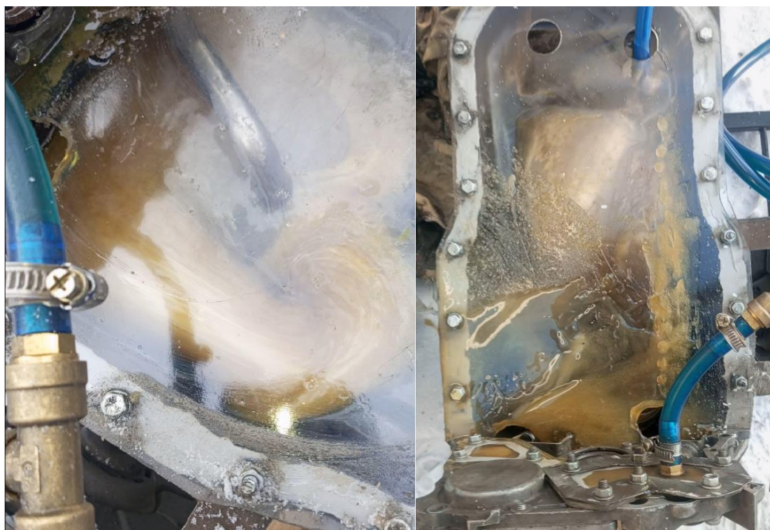
Рис. 6. Фрагмент процесса смешивания и подачи воздушно-масляной эмульсии в масляную систему
