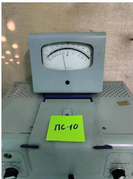
Рисунок 9 – Показания концентрации протравителя на обработанных семенах с помощью ПС-10
