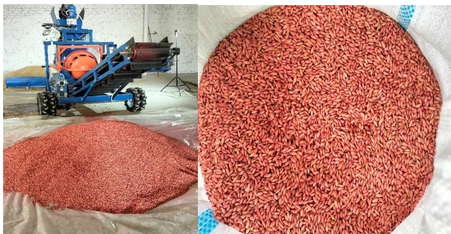
Рисунок 10 – Отбор проб семян от опытного образца протравителя семян
