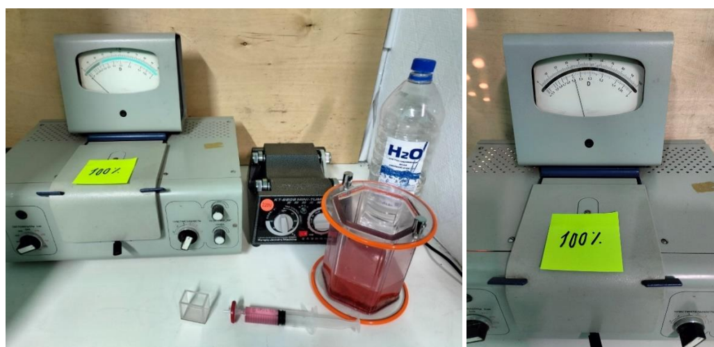
а – подготовка раствора для исследования; б - показания КФК-2 Рисунок 6 – Исследование образцов смывов с протравленных семян разной концентрации.
