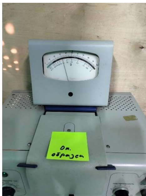
Рисунок 11 – Показания концентрации протравливателя на обработанных семенах с помощью опытного образца
