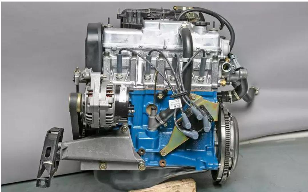
Рисунок 1 – Внешний вид ДВС серии ВАЗ 21116 рабочего объема 1,6 литра с чугунным блоком
