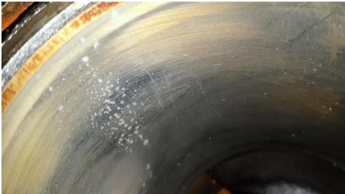
Рисунок 4 – Внешний вид хона на стенке цилиндра, свидетельствующий о неравномерности износа стенок
