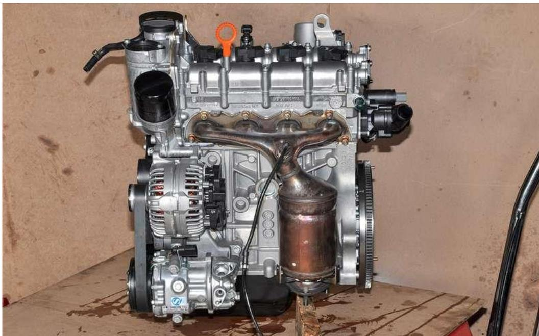
Рисунок 2 – Внешний вид полностью алюминиевого ДВС концерна Volkswagen серии SAHA рабочим объемом 1,6 л
