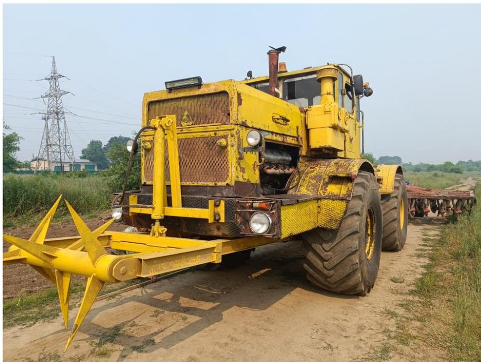
Рисунок 1 – Применение фронтального прокальвателя-щелереза в составе комбинированного МТА
