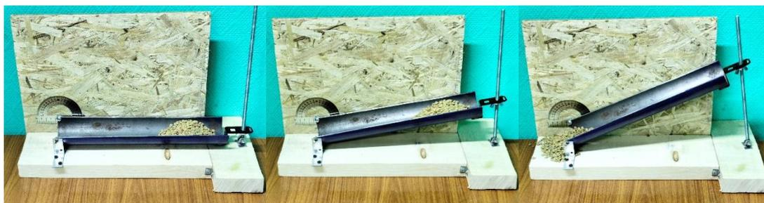
Рисунок 7 - Определение угла скольжения семян чечевицы
