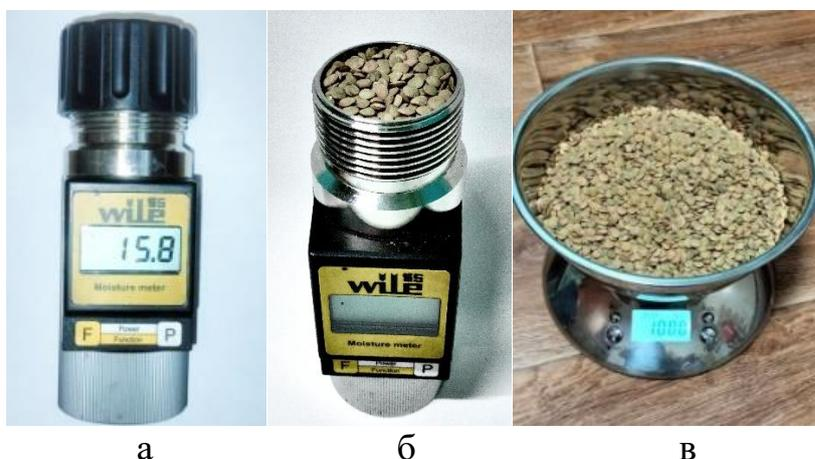
а – замер влажности зерна; б - влагомер зерна Wile 55; в – весы электронные с чашей.
