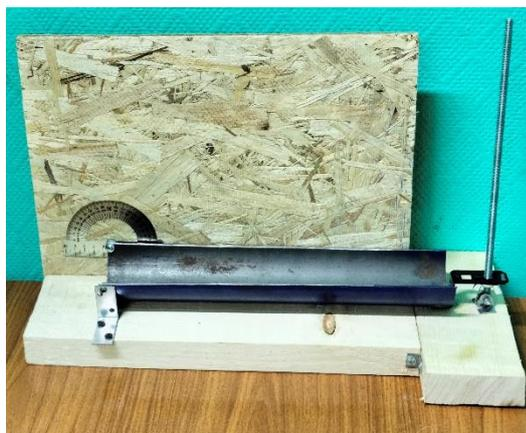
Рисунок 6 - Платформа для измерения угла скольжения семян чечевицы
