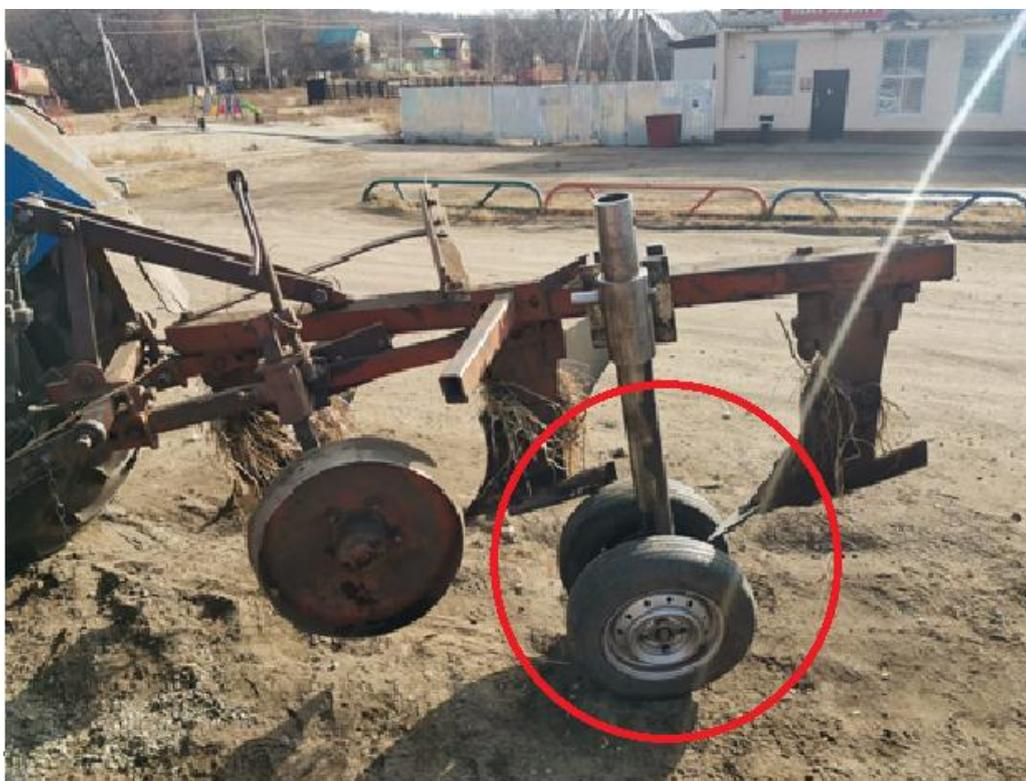
Рис. 1. Весораспределяющее устройство, установленное на плуг ПЛН 3-35 (положение транспортировки)
