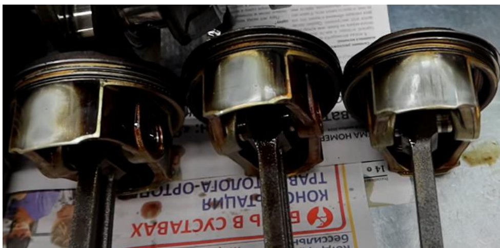
Рисунок 4 – Изношенные поверхности юбок поршней второго ряда
