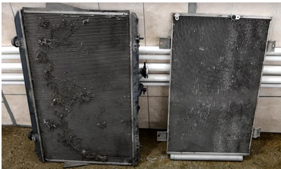
Рисунок 5 – Пакет загрязненных радиаторов автомобиля «Тойота Хайлендер»
