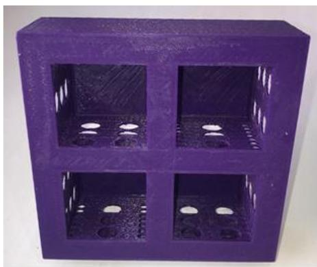
Рисунок 1 – Распечатанная модель сепаратора на 3D-принтере
