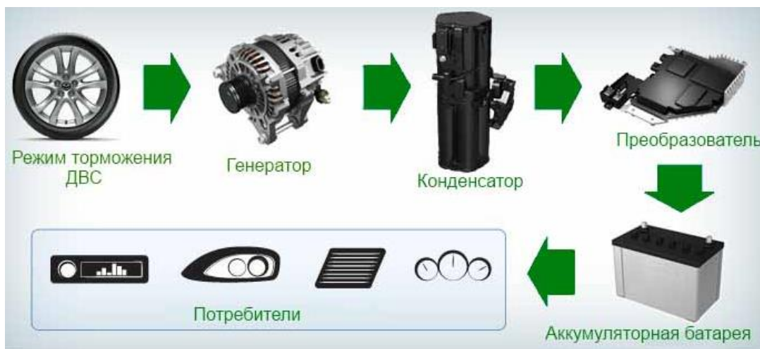
Рисунок 1 – Общий вид системы рекуперативного привода ТС
