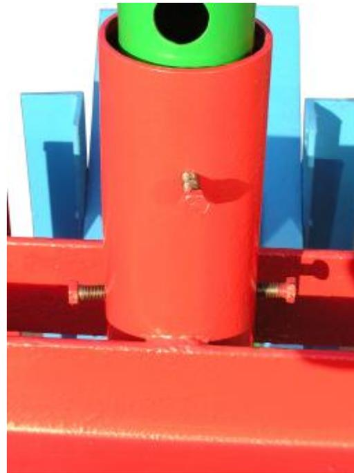
**Рисунок 5 – Регулировки высоты установки трубы**
