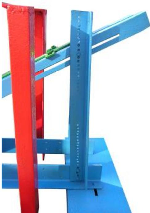
**Рисунок 4 – Регулировка угла наклона пластин**
