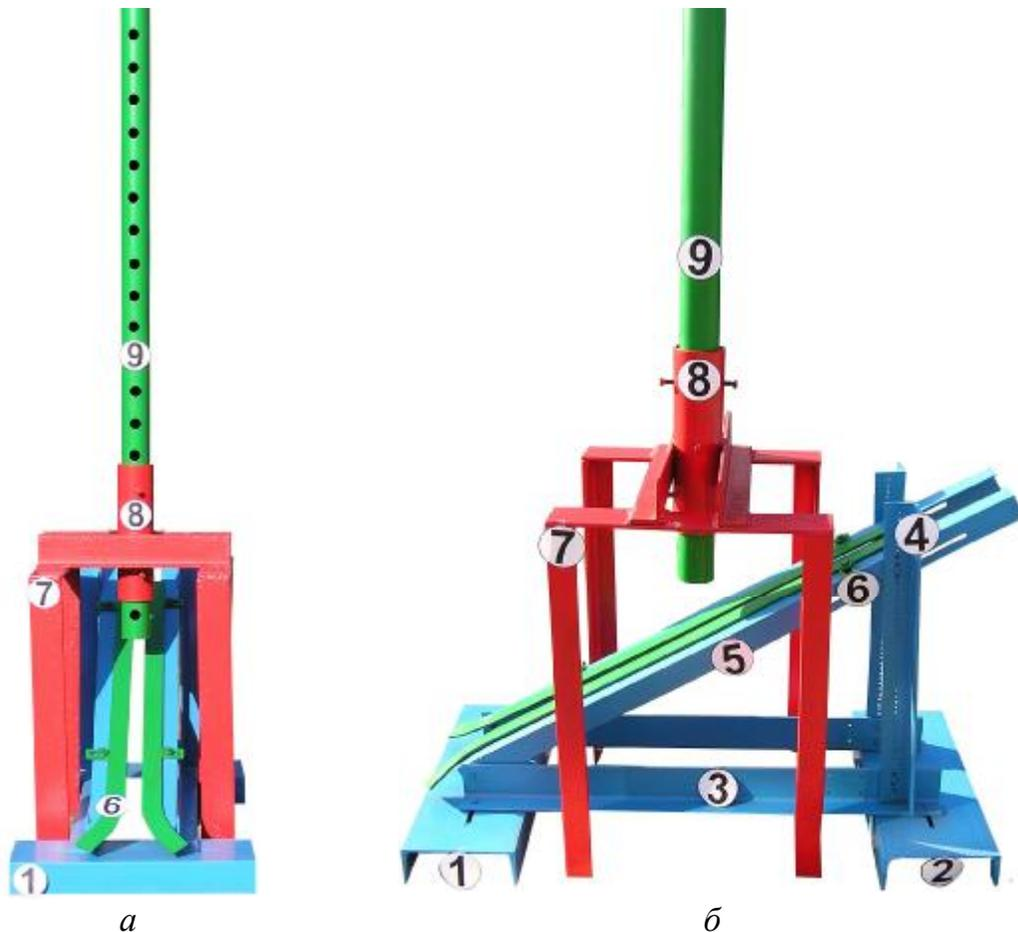
**Рисунок 1 – Установка для определения допустимого ударного импульса: *а* – вид спереди; *б* – вид слева; 1,2 – опоры; 3 – основание; 4 – вертикальная стойка; 5 – наклонная стойка; 6 – початкоотделяющие пластины; 7 – рамка; 8 – держатель; 9 – труба**
