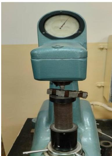
Рисунок 2 – Прибор Роквелла для измерения твердости поверхности детали
