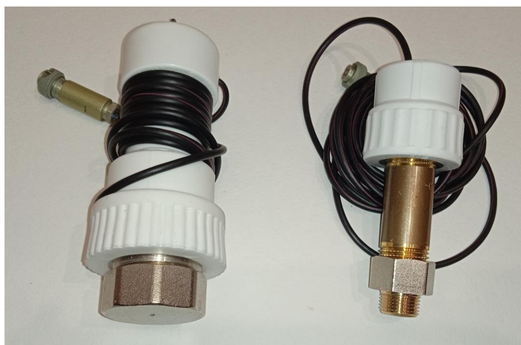
Рисунок 3 Сменные датчики блока мониторинга (слева поисковый справа стационарный, с переходником для монтажа на системе))
