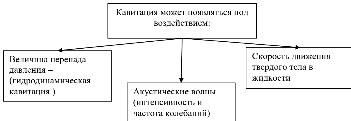
Схема 1 - Источники возникновения кавитации
