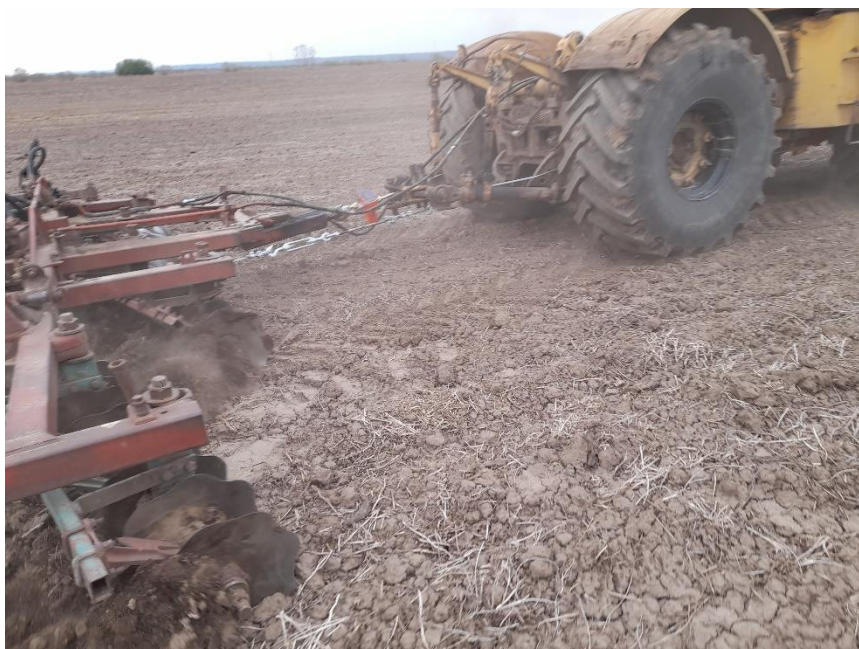
Рисунок 1 – Машинно-тракторный агрегат (К-701+т БДТ-7 + корректор-распределитель сцепного веса)
