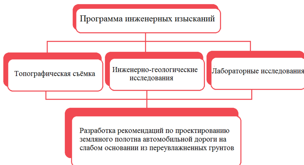
Рисунок 4 – Программа проведения инженерных изысканий
