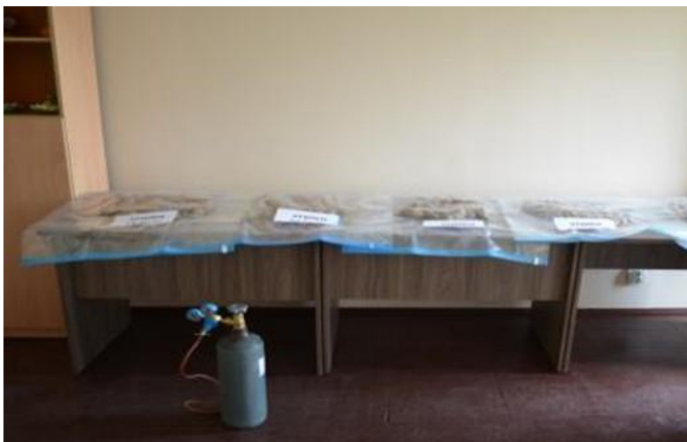
Рисунок 1. - Обработка клубней картофеля различными концентрациями этилена в герметичных пакетах
