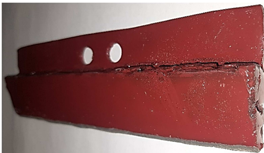
Рисунок 2 – Экспериментальная лопатка-нож-полуклин многоцелевого смесителя-измельчителя
