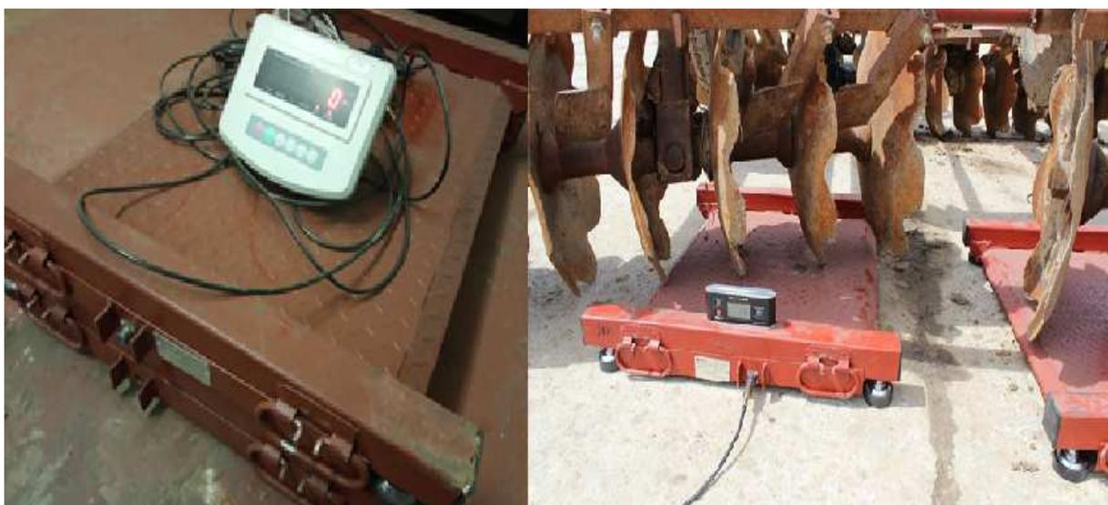
Рис. 3 – Определение нагрузки приходящейся на диски бороны
