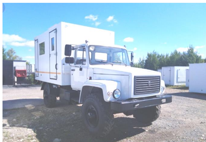
Рисунок 1 – Передвижная авторемонтная мастерская ПРМ ГАЗ-33081
