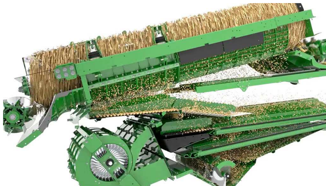
Рисунок 1 – Система очистки комбайна компании John Deere
