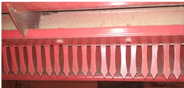
Рисунок 2 – Гребёнки с изменяющимися зазорами по длине пальца
