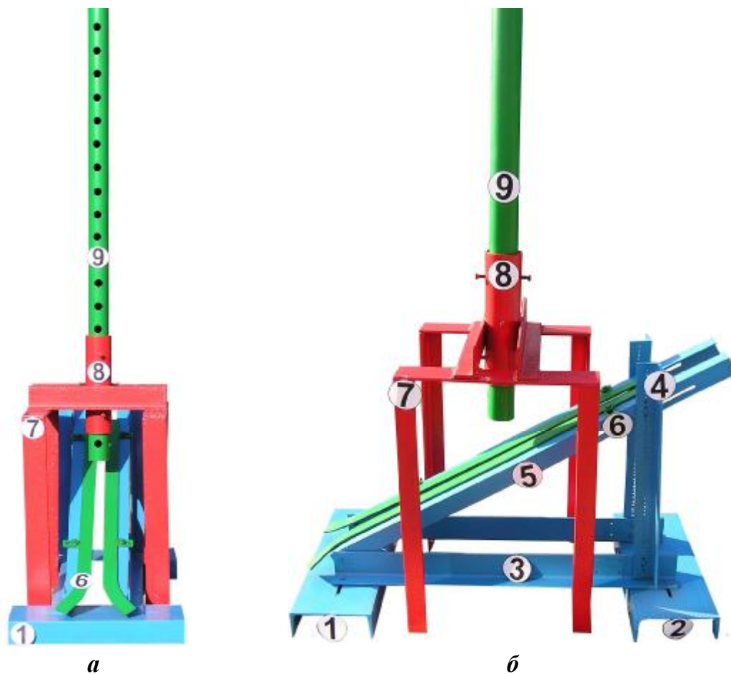
Рисунок 5 – Установка для определения допустимого ударного импульса: а – вид спереди; б – вид слева; 1, 2 – опоры; 3 – основание; 4 – вертикальная стойка; 5 – наклонная стойка;
