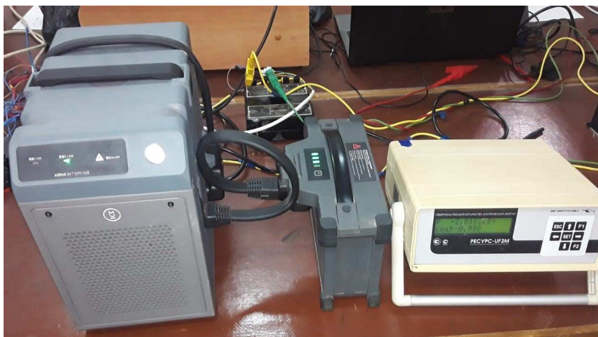
Рисунок 2 – Фото экспериментального стенда измерения показателей качества электроэнергии в процессе заряда АКБ VAX501-9500 -51.8 зарядным устройством DJI CHX503-3500
