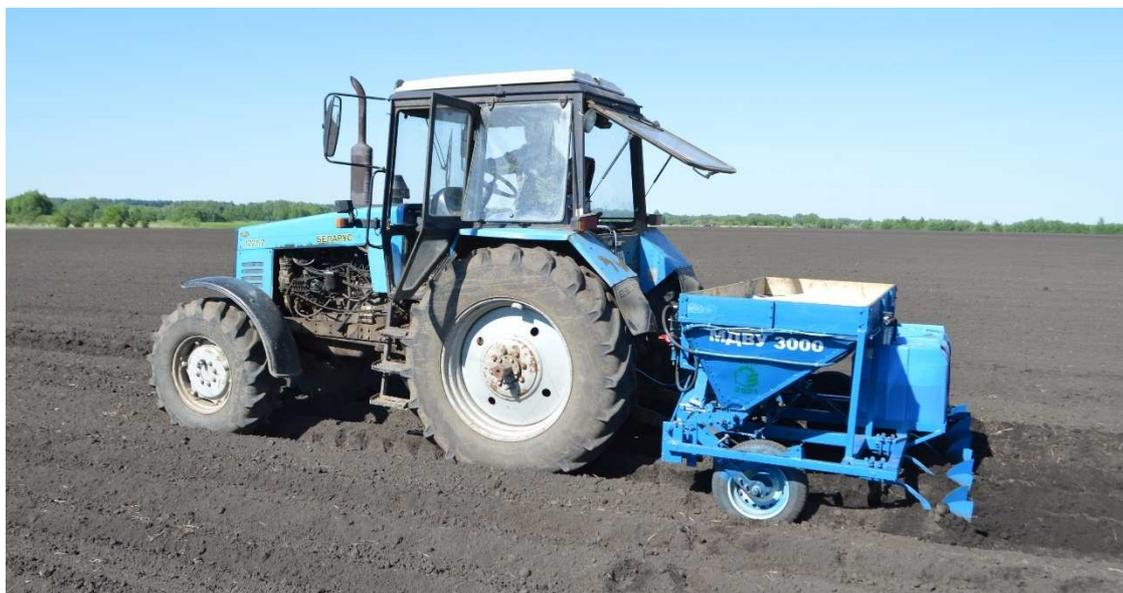
Рисунок 1 – Внесение твердых минеральных удобрений и раствора гуматов при помощи гребнеобразующего культиватора-подкормщика МДВУ-3000
