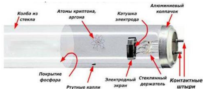
Рисунок 1-Устройство люминесцентной лампы
