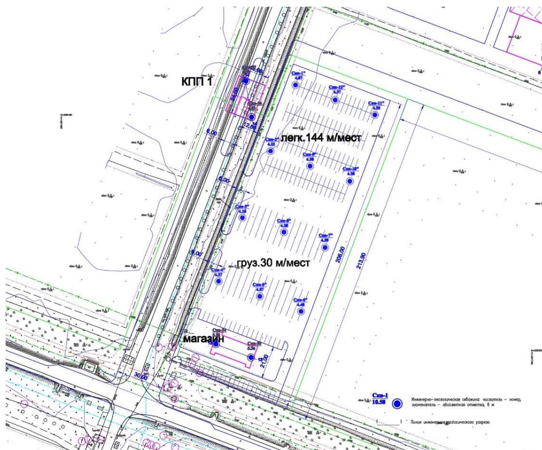
Рисунок 3 – Расположение дополнительных изыскательских скважин на участке парковки автотранспорта
