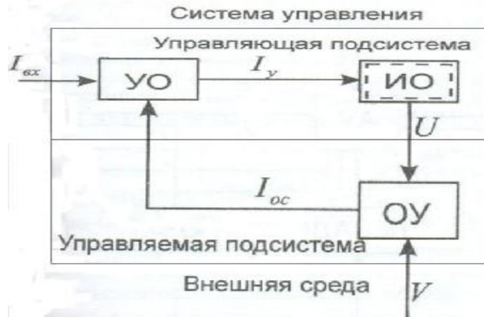
Рисунок 2 – Классическая схема системы управления
