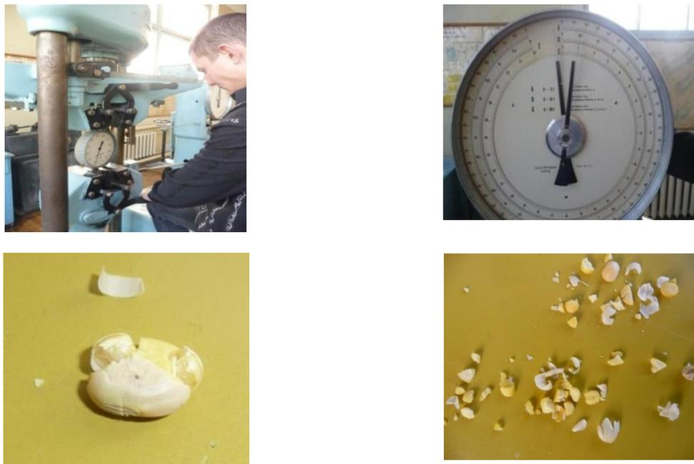
Рисунок 5 – Установление зависимости разрушения разбухших зерен путем приложенного давления
