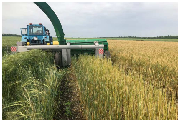
Рисунок 6 – Уборка зерновых колосовых культур на ранних стадиях спелости агрегатом для уборки урожая методом очеса на корню
