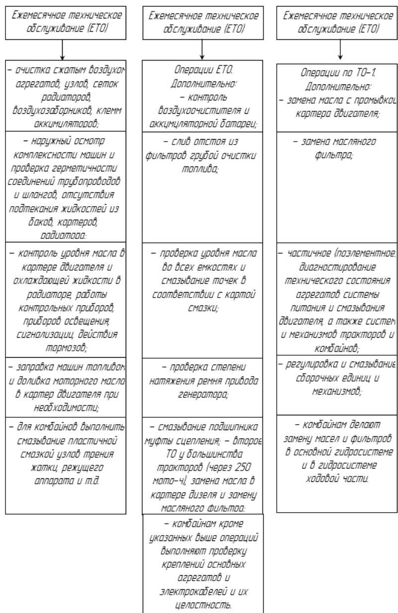
Рисунок 7 – Схема содержания операций ТО сельскохозяйственной техники, выполняемых на стационарных пунктах ТО и с помощью передвижного агрегата ТО ПРОА-1
