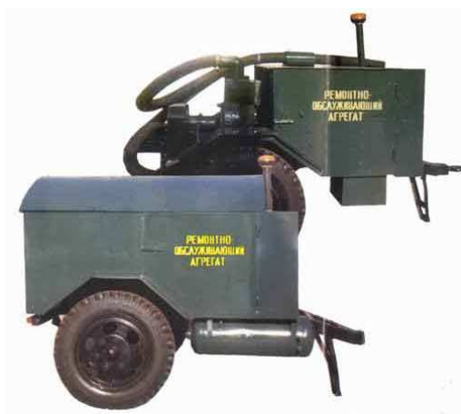
Рисунок 5 – Прицепной ремонтно-обслуживающий агрегат ПРОА-1
