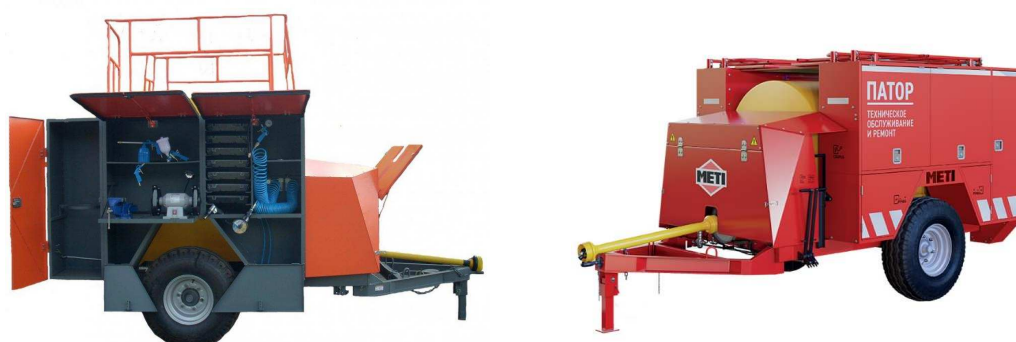
Рисунок 6 – Передвижной агрегат технического обслуживания и ремонта «ПАТОР»
