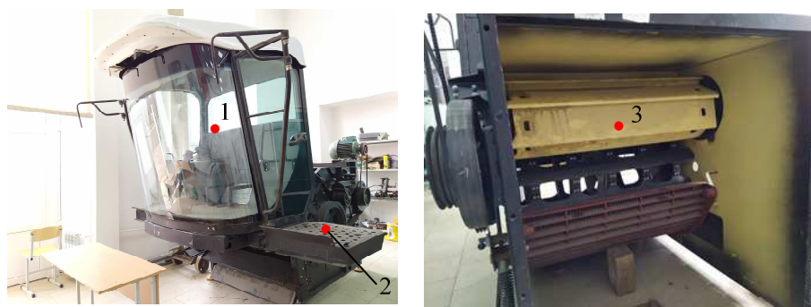
Рисунок 1 – Испытательный стенд шума и точки замеров на нем.
