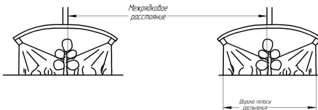
Рисунок 4 - Направленное действие распылителей ConeJet.
