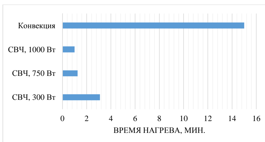
Рисунок 4 - Время (мин), необходимое для нагрева 100 гр материала до температуры 60 °С
