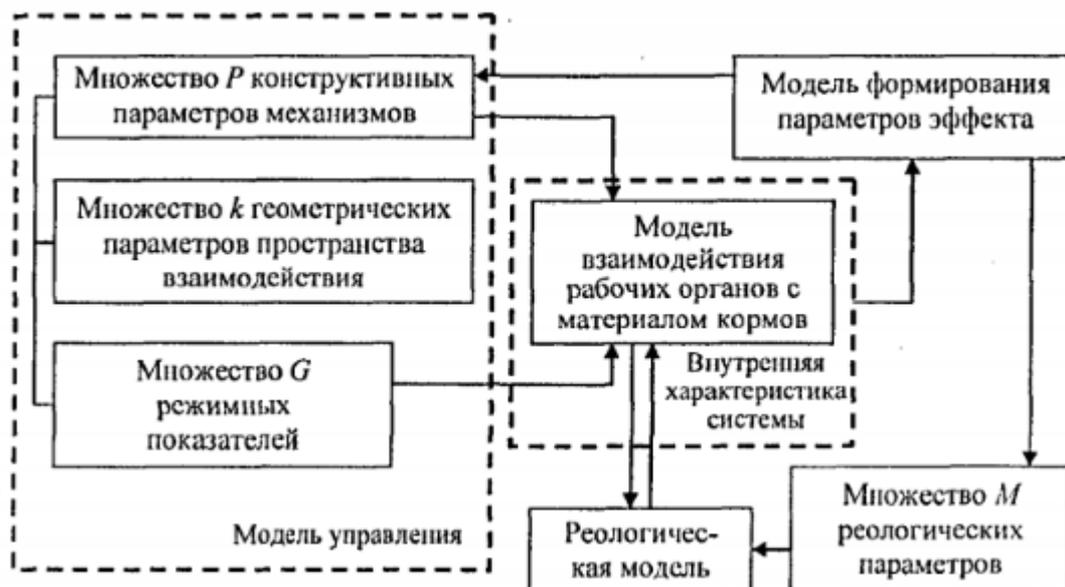
Рисунок 1 – Структура математической модели процесса кормоприготовления с помощью пресс-экструдера
