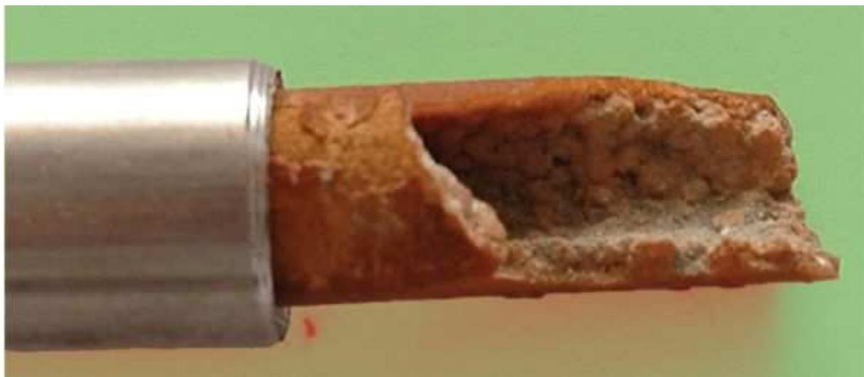
Рисунок 3 - Отложение накипи в теплообменной трубке
