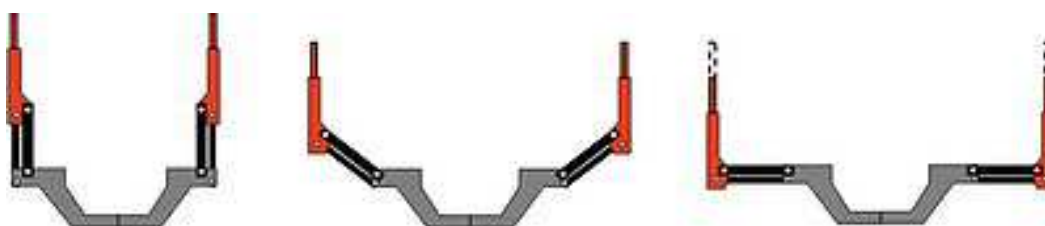
Рисунок 4 – Коник форвардера Komatsu с механизмом расширения погрузочного пространства (FlexBunk)
