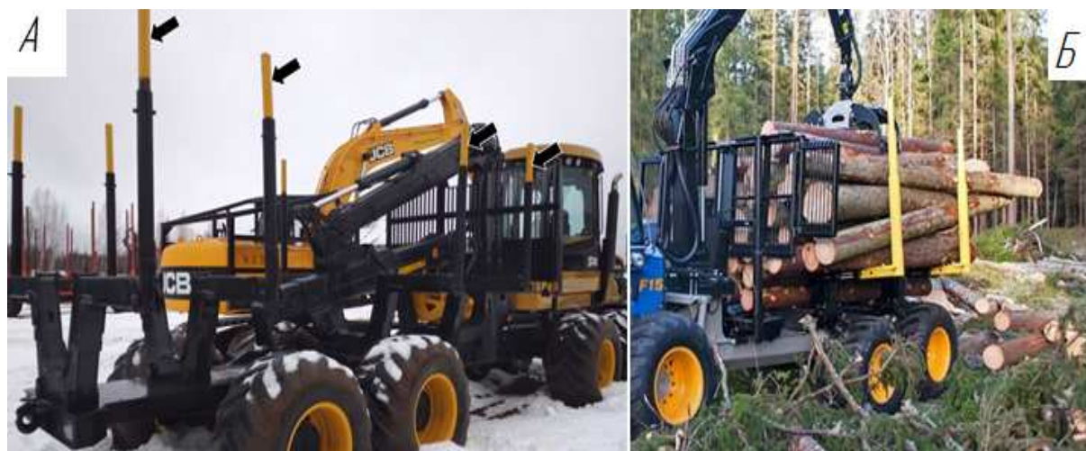
А – EcoLog (расширители указаны стрелкой); Б – Rottne с гидроприводом вертикальных расширителей
