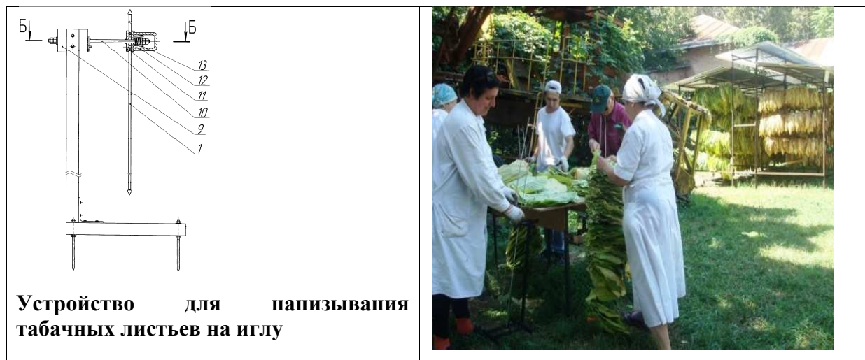
Рисунок 1 – Заполнение листьями ДДИ при помощи устройства для нанизывания табачных листьев на иглу
