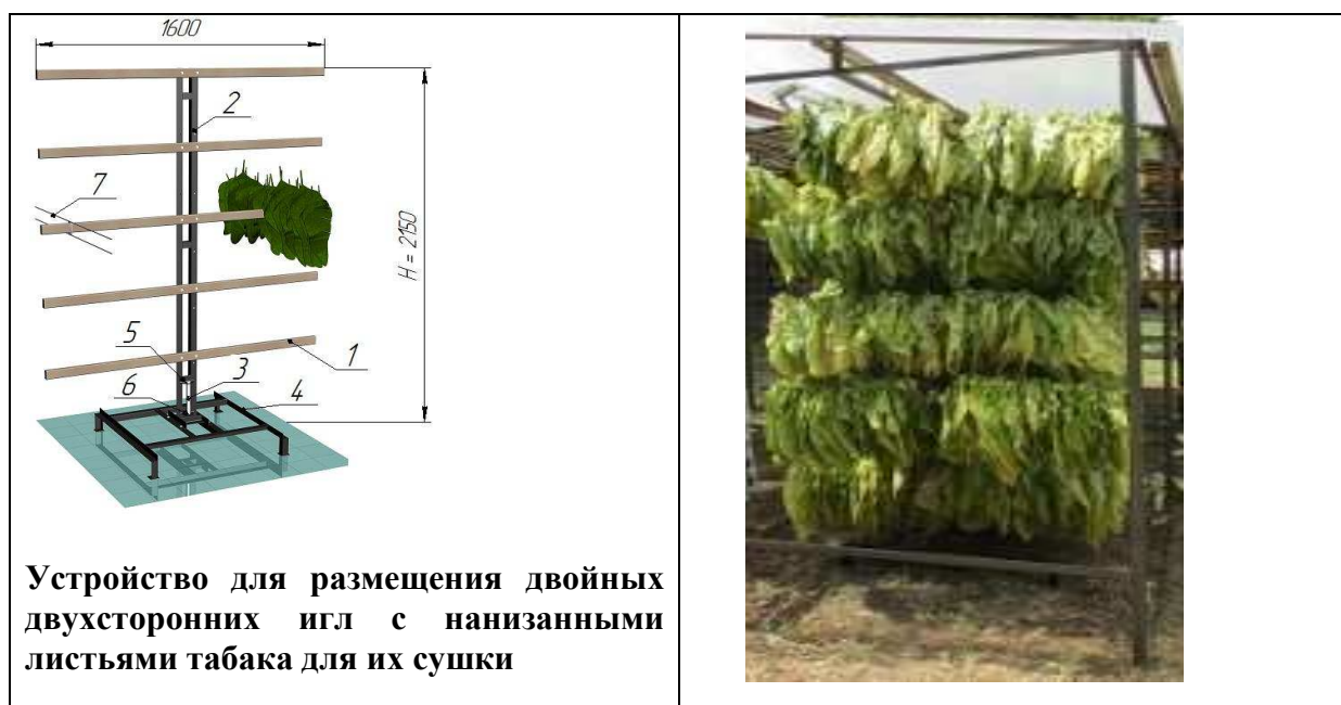
Рисунок 2- Заполнение устройства для размещения двойных двухсторонних игл с нанизанными листьями табака для их сушки
