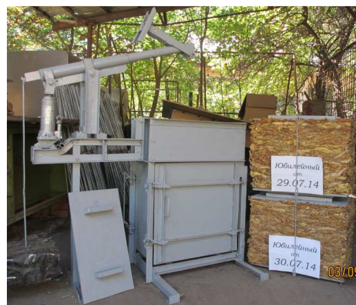
Рисунок 4 – Пресс для изготовления табачных кип
