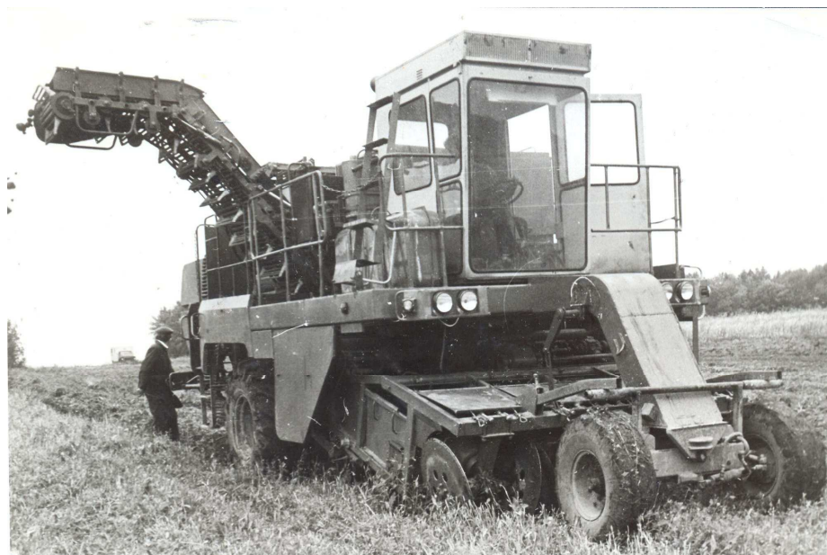
Рисунок 5 – Самоходный четырехрядный картофелеуборочный комбайн КСК-4А-1 (СССР)
