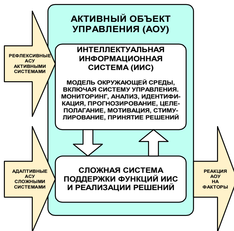
Рисунок 3. Различие в характере управляющего воздействия на активный объект управления в рефлексивных и классических автоматизированных системах управления
